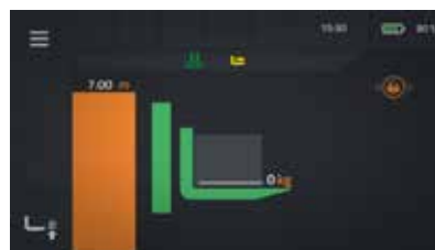
Forche sollevate a un'altezza di sollevamento di 7,00 m
