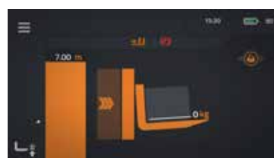
Forche brandeggiate e traslate, montante esteso
