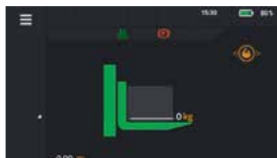
Montante, forche e traslatore laterale in posizione neutra
